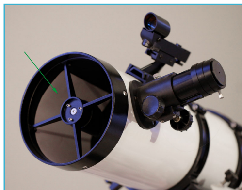
STELESCOPE 130 prêt pour la collimation. La flèche verte indique la feuille de papier blanc positionnée à l'opposé du porte-oculaire.
