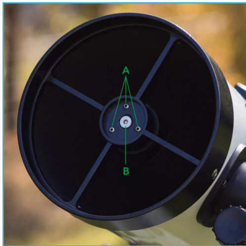
Avant du tube optique du STELESCOPE 130 avec les trois vis de réglage (A) et la vis centrale de fixation (B) du miroir secondaire, au centre de l'araignée.
