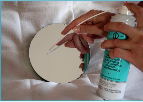
7. S'il reste des gouttelettes d'eau, utilisez une bombe d'air sec (à garder bien à la verticale pour ne pas expulser le gaz propulseur givrant sur l'aluminure) ou une poire pour souffler l'eau vers le bas du miroir. Vous pouvez aussi effleurer les gouttes d'eau avec un chiffon propre et non pelucheux pour les ôter par capillarité.
