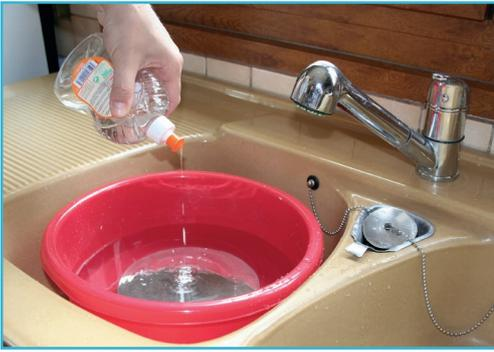
2. Remplissez la cuvette d'eau tiède et déposez-y le miroir, aluminure vers le haut. Ajoutez quelques gouttes de détergent pour la vaisselle et agitez l'eau pour mélanger sans toucher à la surface. Si le miroir est très sale, laissez agir quinze à trente minutes puis reprenez à l'étape 1. Sinon, laissez agir trois à quatre minutes et passez à l'étape 3.
