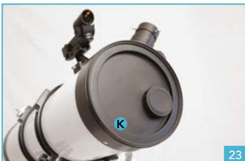
23. Le bouchon du tube optique **K**.
