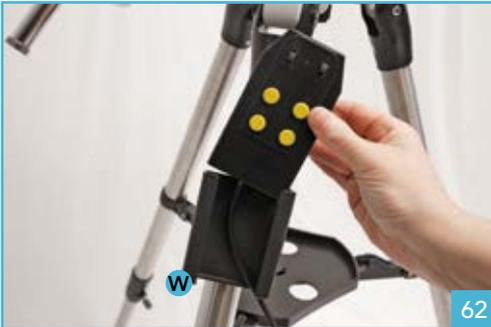
62. Installez le support de raquette de commande **W** sur l'un des pieds et placez la raquette de commande dans son support.
