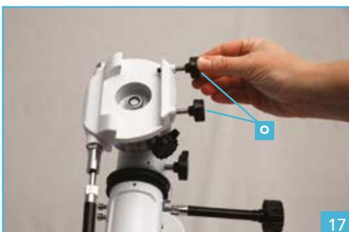
17. Sur la platine, desserrez les deux vis **o** de la glissière jusqu'à libérer complètement le passage.
