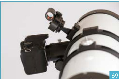
69. La photographie au foyer est une technique bien adaptée aux objets du ciel profond. Elle nécessite d'utiliser obligatoirement un boîtier à objectifs interchangeables (reflex ou hybride) que l'on solidarise à l'instrument grâce à une bague dite T2 (voir p.31), spécifique à chaque marque de boîtier photo. **Attention, pour le Stelescope 130, une bague T2 ultrafine (épaisseur de 3 mm maximum) est indispensable pour pouvoir atteindre la plage de mise au point.**
