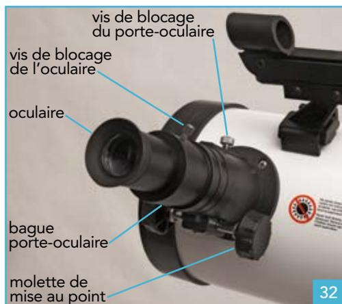
Pour garantir la qualité des images délivrées par le télescope, il est important de soigner la mise au point, c'est-à-dire la netteté de l'image. Elle est obtenue en tournant la molette située à l'arrière du porte-oculaire. Pour réaliser votre première mise au point, visez des éléments du paysage situés à une distance de plusieurs dizaines de mètres (si la distance est trop courte, le réglage sera impossible).
