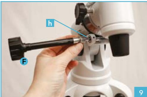
9. Fixez une des molettes de mouvement lent **F** sur l'axe d'ascension droite **h**. Attention à placer correctement l'ergot situé sur la monture dans l'encoche du pas de vis de la molette.
