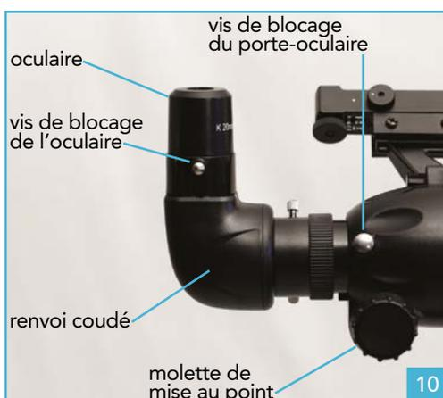
10. Insérez un oculaire et serrez la vis de blocage. Placez votre œil à l'oculaire et tournez la molette de mise au point doucement dans un sens jusqu'à trouver la plage de netteté. Si vous n'y parvenez pas, tournez la molette dans l'autre sens.
