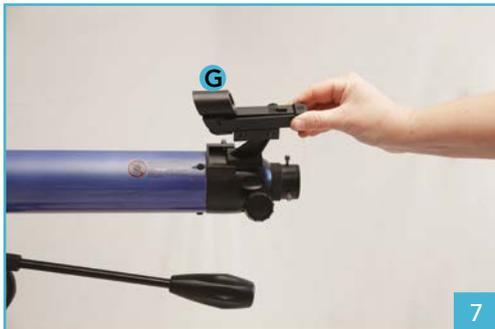
7. Lors de la mise en place, l'objectif du pointeur point rouge doit être placée vers l'avant du tube pour une utilisation correcte. Insérez le pointeur sur la base située à l'arrière du tube optique puis serrez la vis de blocage. Avant la première utilisation et si elle est présente, ôtez la languette en plastique protégeant la pile du pointeur point rouge.
