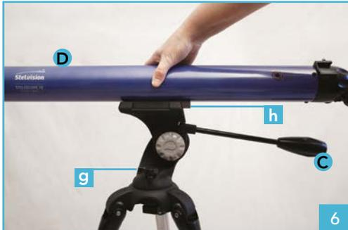
6. Positionnez la platine à l'horizontale et serrez la manette de direction **C** et la molette d'azimut **g**. Insérez la queue d'aronde **h** du tube **D** dans la glissière et serrez les vis **f**.
