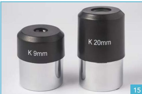
15. Le choix du grossissement est fonction du type d'objet observé et des spécifications techniques de l'instrument. Le STELESCOPE 70 est livré avec deux oculaires de 20 et 9 mm de focale qui délivrent des grossissements respectifs de 45 et 100 fois (voir aussi p.11 le calcul du grossissement) et il peut supporter des grossissements jusqu'à 150 fois environ, à condition de se procurer les oculaires adéquats et que la qualité du ciel le permette.
