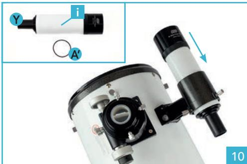
10. Placez le joint torique **A** autour du chercheur **Y**, à l'endroit de la gorge **i**. Puis insérez l'ensemble dans son support jusqu'à ce que le caoutchouc soit en butée à l'avant ; resserrez les vis de réglage.
