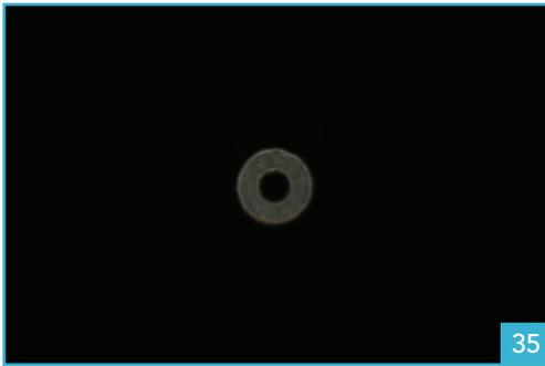
35. La lumière de l'étoile s'étale alors sous la forme d'un disque avec un disque sombre au centre. Si le disque sombre est parfaitement centré dans le disque lumineux et que les deux sont circulaires, alors la collimation est correcte.
