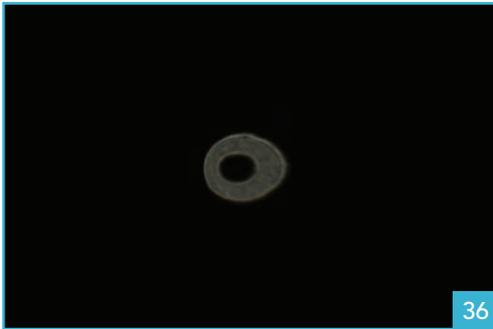
36. Si le disque sombre est décentré par rapport au disque lumineux et qu'on constate une ovalisation, alors il faut collimater l'instrument.
