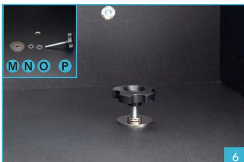
6. Insérez sur le filetage de la molette d'azimut **P** la petite rondelle **O**, puis le roulement à billes **N** et enfin la grande rondelle **M**. Vissez cet ensemble au centre de la base.
